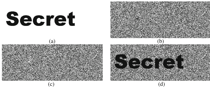
Fig. 1. A (2, 2) -VCS, (a) Secret image, (b) Share 1, (c) Share 2, (d) Recovered secret image.
